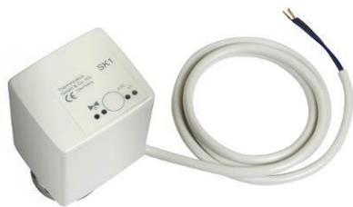
Le moteur de vanne proportionnel Thermozyklus ou équivalent sera installée sur chaque radiateur, panneaux ou boucle de PCBT, dont le corps sera thermostatizable. Ce même corps sera de type linéaire M30x1,5.
