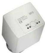
Moteur SF : A placer sur corps thermostatizable M30x1.5, connecté en radio et alimenté par 2 piles LR6, il permet une régulation proportionnelle de l'émetteur.
