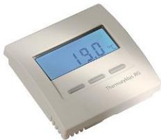
Sonde RG : A placer en ambiance, 1.50m du sol, pas sur paroi froide, connectée et alimentée par fil bus, elle permet la mesure de la température d'ambiance et le réglage de la consigne ainsi que des modes.
