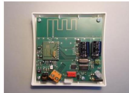
Diese Nummer kann mithilfe von 2 Jumpfern rechts unten auf der Platine eingestellt werden. Dabei ist gleichgültig, welches Gerät welche Nummer erhält. Auch das einzige Gerät an einer ZE kann eine beliebige Nummer zwischen 1 und 4 erhalten. Wichtig ist nur, daß nicht zwei Geräte an einer ZE dieselbe Nummer haben. Es ist also egal, wie die Jumper stecken, sie müssen nur unterschiedlich stecken.
