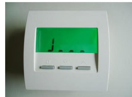
Hier ist die Verbindung zu Stellantrieb 0 noch gut. Zu den Stellantrieben 1, 2, 3 besteht keine Funkverbindung.
