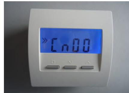
Mit dem CN-Code der Konfiguration kann das Verhalten des Raumgeräts RG verändert werden, insbesondere auch die angezeigten Menü-Punkte. Dabei bedeuten:
