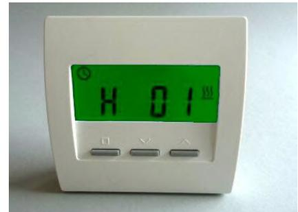
Nach 20 Sekunden ohne Tastendruck wird das Menü automatisch verlassen und zur Schaltuhr-Anzeige zurückgekehrt.
