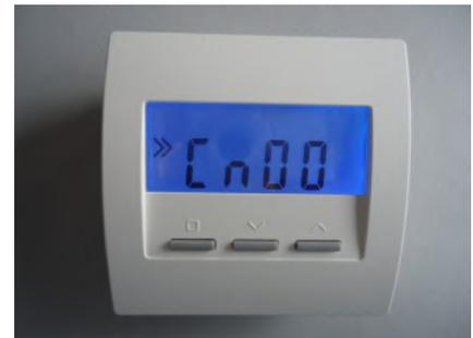
Jedes Raumgerät RG oder RS oder RF muß eine eigene Geräteadresse zwischen 1 - 30 haben. Diese Geräteadresse dient zur eindeutigen Identifizierung des Gerätes innerhalb des Bussystems einer Zentraleinheit ZE. Eine Geräteadresse darf innerhalb derselben Gerätegruppe RG/RS/RF und derselben ZE nur einmal vergeben werden. Innerhalb einer anderen Gerätegruppe (z.B. ST/SK/SF/) oder einer anderen ZE ist eine nochmalige Vergabe aber erlaubt und oft sogar sinnvoll oder notwendig.
