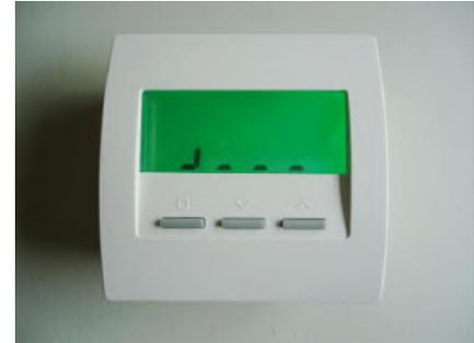
Hier ist die Funkverbindung auch zu Stellantrieb 0 schon für längere Zeit ausgefallen.
