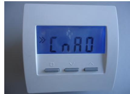
Jetzt die linke Taste noch einmal drücken das Programmiersymbol >> blinkt. Nun kann die Konfiguration mit den beiden anderen Tasten eingestellt werden:
