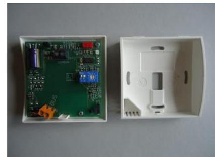
ZE darf nicht an das Stromnetz angeschlossen sein. Eine Montage unter Spannung beschädigt an sich das Raumgerät RS nicht. Es besteht aber die Gefahr, dass die während der Montage noch losen Anschlussdrähte unbeabsichtigt andere Teile der Elektronik berühren und dadurch eine Beschädigung eintritt !
