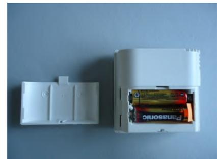
Jetzt 2 spitze Schrauben an den beiden kleinen Vertiefungen des Batteriedeckels rechts und links ansetzen und den Deckel an der Wand festschrauben. Ev. muß vorher der Batteriedeckel und die Wand vorgebohrt werden. Der Abstand zwischen den beiden Schraublöchern beträgt 36 mm. Siehe im Übrigen die Maßzeichnung unten.
