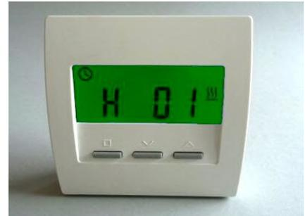
Nach 20 Sekunden ohne Tastendruck wird das Menü automatisch verlassen und zur Schaltuhr-Anzeige zurückgeführt.
