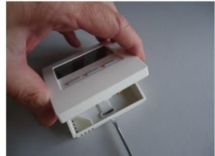
Die Batterien befinden sich im Oberteil auf der Elektronik-Platine. Sie können mit einem Schraubenzieher vorsichtig in Richtung Platinenrand aus ihren Haltern geschoben werden. Beim Einsetzen der neuen Batterien auf die Polung achten. Die korrekte Polung ist auf den Batteriehaltern markiert.
