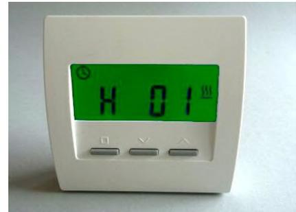
Ein Bindestrich zwischen dem Buchstaben H und der Zahl bedeutet, daß der Schaltpunkt deaktiviert ist (z.B. H-05). Fehlt der Bindestrich, ist der Schaltpunkt aktiv (z.B. H 01).
