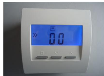
übernimmt die Einstellung und wechselt zur Einstellung der Systemadresse. Jedes Raumgerät RF muß eine eigene Geräteadresse zwischen 1 - 30 haben. Diese Geräteadresse dient zur eindeutigen Identifizierung des Gerätes innerhalb aller Geräte mit derselben Systemadresse. Geräte innerhalb desselben Gebäudes müssen eine eigene Geräteadresse, sie können aber dieselbe Systemadresse haben. Geräte in verschiedenen Gebäuden sollten unterschiedliche Systemadressen aufweisen.
