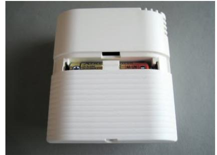
Werden die Batterien schwach, wird dies durch ein Batterie-Symbol in der Anzeige signalisiert. Außerdem wird eine entsprechende Meldung an die Zentraleinheit ZE gefunkt, die dann ebenfalls durch ein Batterie-Symbol im Status-Menü auf die Notwendigkeit eines Batterie-Wechsels hinweist.
