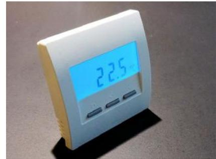
Die Stromversorgung erfolgt über 2 Knopfzellen (Lithium CR2455). Dadurch kann das sehr flache Gehäuse eines Raumgeräts RG verwendet werden, was eine optisch ansprechende Montage an der Wand erlaubt.
