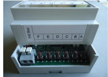
An jeden der 6 Ausgänge können je 2 Solid State Relais (SSR) angeschlossen werden (insgesamt aber nicht mehr als 8 SSR). Die SSR müssen über einen potentialfreien Eingang verfügen (üblicherweise einen Optokoppler). Die Verbindung erfolgt über eine 2-adrige Leitung, die polrichtig verdrahtet werden muß. Die Polarität ist auf dem Gehäuse angegeben.
