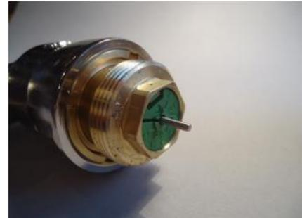
Der Stößel kann manuell in die Stellung "offen" zurückgefahren werden, indem die Taste länger als 5 Sekunden gedrückt und dann noch einige Zeit gedrückt gehalten wird. (Manchmal ist dafür auch ein zweiter Tastendruck nötig.) Der Stößel fährt nach jedem Tastendruck wechselweise in die eine oder andere Richtung bis zum Anschlag.
