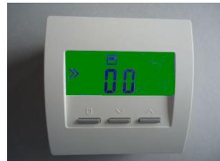
Jedes Raumgerät RF muß eine eigene Geräteadresse zwischen 1 - 30 haben. Diese Geräteadresse dient zur eindeutigen Identifizierung des Gerätes gegenüber den zugehörigen Schaltstufen.
