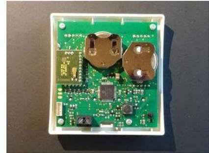
Zum Schließen des Raumgerätes RFW das Oberteil mit leichtem Druck von oben in die kleinen Nasen an der oberen Schmalseite des Unterteils einhängen und nach unten anklappen. Darauf achten, dass sich die Anschlussdrähte eines externen Sensors nicht verheddern. Der Verschlusshaken rastet hörbar ein, wenn man von oben mittig auf die entsprechende Stelle drückt.
