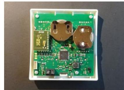
Falls ein externer Sensor oder ein Schalter verwendet werden soll, dessen Anschlußdrähte an die grau-schwarze Klemme anschließen. Die Polarität gleichgültig.
