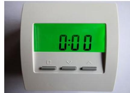
Nach 20 Sekunden ohne Tastendruck wird das Menü automatisch verlassen und zum zuvor eingestellten Menü zurückgekehrt.
