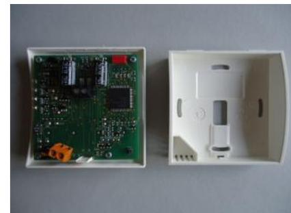
ZE darf nicht an das Stromnetz angeschlossen sein. Eine Montage unter Spannung beschädigt an sich das Raumgerät RG nicht. Es besteht aber die Gefahr, dass die während der Montage noch losen Anschlussdrähte unbeabsichtigt andere Teile der Elektronik berühren und dadurch eine Beschädigung eintritt !
