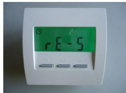
Anzeige bei Fehlender Funkverbindung
