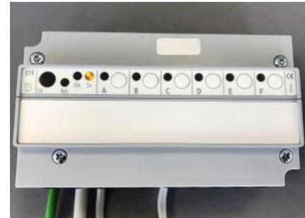
Jeder verwendete Kanal der Schaltstufe ST muß eine eigene Geräteadresse zwischen 1 - 30 haben. Diese Geräteadresse dient zur eindeutigen Identifizierung des Kanals innerhalb des Bussystems einer Zentraleinheit ZE. Eine Geräteadresse darf innerhalb derselben Gerätegruppe ST/SK/SF/STE und derselben ZE nur einmal vergeben werden. Innerhalb einer anderen Gerätegruppe (z.B. RG/RS/RF) oder einer anderen ZE ist eine nochmalige Vergabe aber erlaubt und oft sogar sinnvoll oder notwendig.
