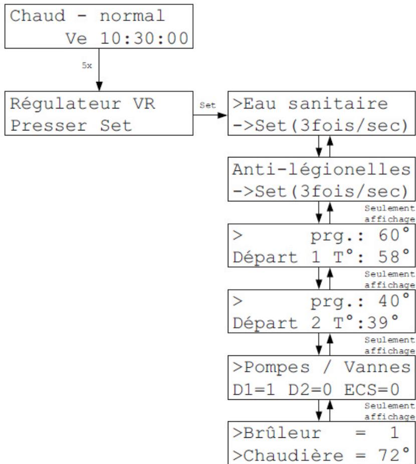
La température de l'eau chaude sanitaire peut être modifiée dans le Menu Régulateur VR. De plus, on peut régler si l'eau chaude sanitaire doit être chauffée une fois par semaine à plus de 60°C comme protection anti-légionelle. Les données de fonctionnement du régulateur de départ VR sont affichées.
