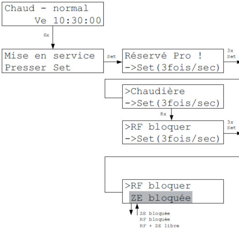
Dans le Menu RF Bloquer, on peut déterminer où la température de consigne des unités locales RF peut être entrée : soit dans l'unité locale RF (RF Bloquer est inactif), soit dans l'unité centrale ZE (RF Bloquer est actif), ou à la fois dans RF et ZE (RF+ZE libre).
