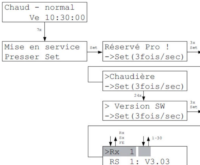
Dans le Menu SW Version, il est possible d'interroger la version Software du matériel raccordé au Bus, si les appareils soutiennent cette fonction.
