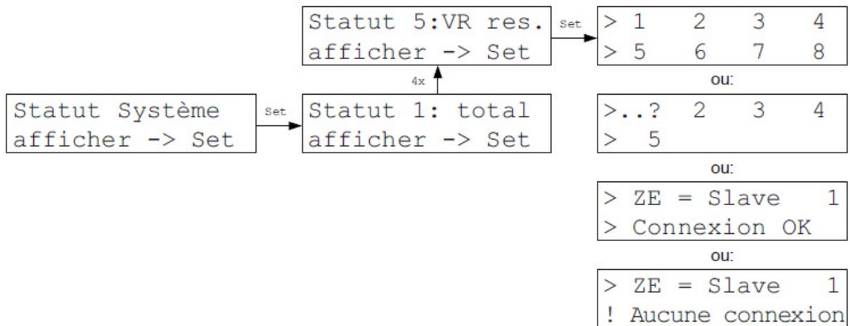
Dans le Menu Statut 5 : VR Réseau sont indiquées les connexions Modbus vers d'autres ZE.
