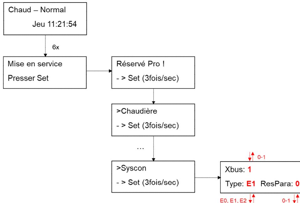
Dans le menu Syscon, on peut modifier des paramètres du système.
