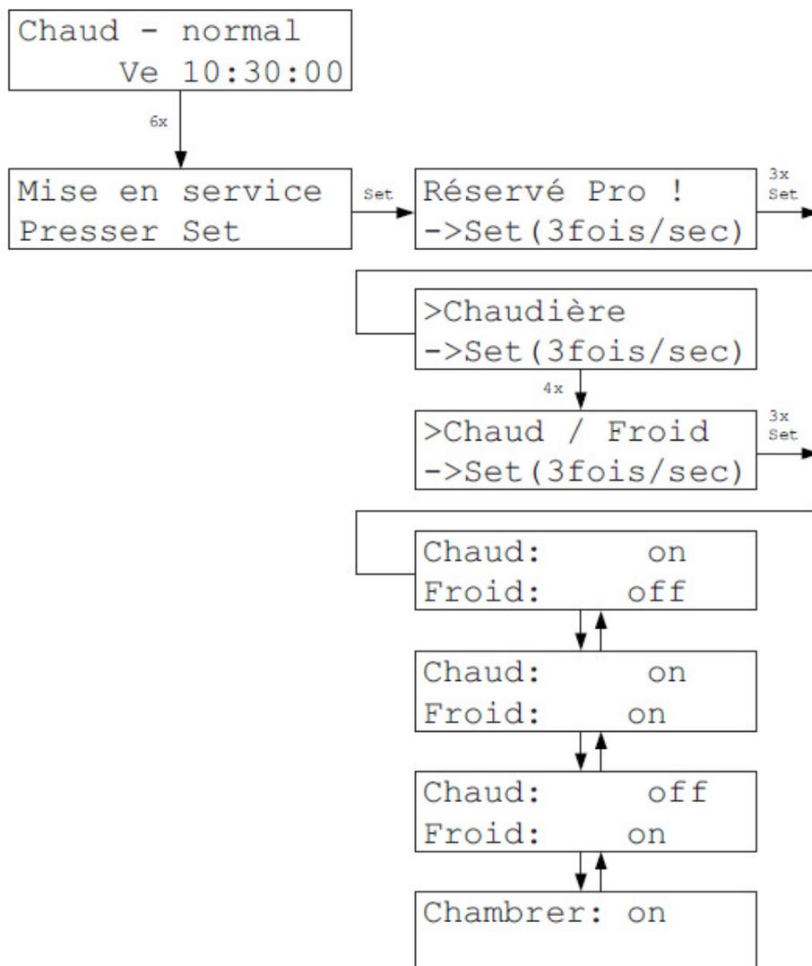
Dans le Menu Chaud / Froid, on peut définir pour quels modes de fonctionnement l'installation est utilisée. Il est possible de choisir « juste chaud », « chaud et froid », « juste froid » ou « chamber (tempérer) ». Il est possible de modifier la fonction dans le menu Réglages uniquement avec le réglage « chaud et froid ». Par défaut, le réglage est « juste chaud ».
