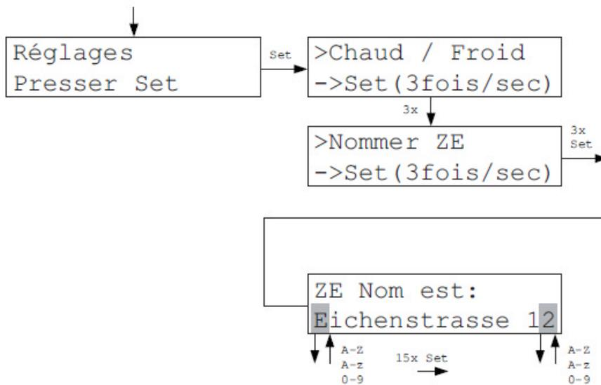
Un nom peut ici être donné à l'unité centrale. Le nom permet une meilleure identification quand l'unité centrale est contrôlée par le logiciel PC-i. Il n'apparaît nulle part ailleurs dans le menu de l'unité centrale.
