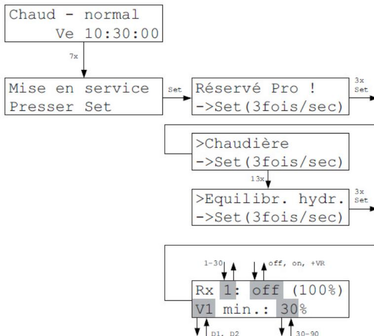
Si des moteurs de vanne SF (à partir de SF2) ou SK sont montés, l'équilibrage hydraulique automatique et dynamique peut être réalisé. Dans le menu « Equilibr. Hydr. », on peut déterminer quelles pièces doivent être équilibrées. Dans la parenthèse, on retrouve le départ lié à la pièce concernée (V1 ou V2).
