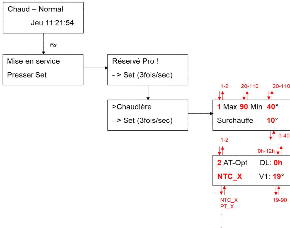
Dans le Menu Chaudière, on peut tout d'abord choisir si la régulation de la chaudière doit se faire via un régulateur de départ VR ou un régulateur de départ VR-AT (optimisation température extérieure AT). Il faut bien entendu que le système comporte un tel régulateur de départ VR ou VR-AT.
