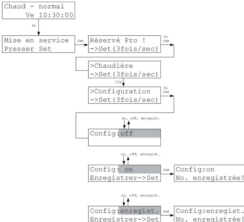
Dans le menu « Configuration », on peut entrer les périphériques installés dans le système actuel. Seuls ces périphériques seront à l'avenir acceptés et pris en compte pour la surveillance des erreurs par la ZE. On évite ainsi que d'autres périphériques ne se connectent ou soient retirés involontairement.
