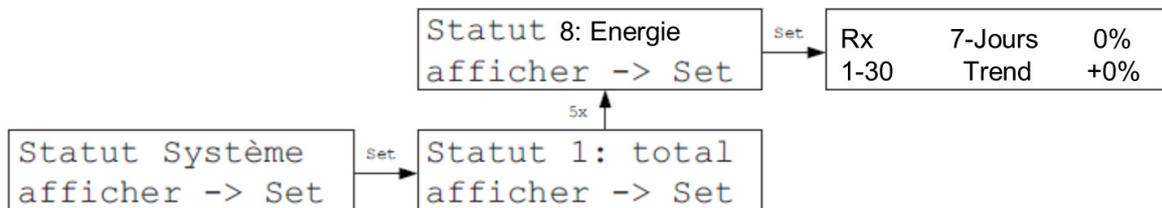
Le Statut 8 : Energie indique une estimation de la demande énergétique de l'installation. Ces données peuvent être chargées pour l'ensemble des pièces (1-30) ou chaque pièce séparément.
