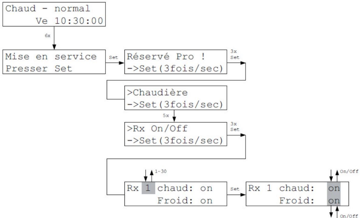
Dans le Menu Rx On / Off, on peut entrer pour chaque unité locale et chaque mode de fonctionnement (Chaud ou Froid), si l'unité locale doit être active (allumée) dans tel mode de fonctionnement ou non. On peut ainsi par exemple éteindre certaines pièces dans le mode de fonctionnement Froid. Lors de la livraison, tous les Rx sont actifs (on) dans les deux modes de fonctionnement (Chaud et Froid).
