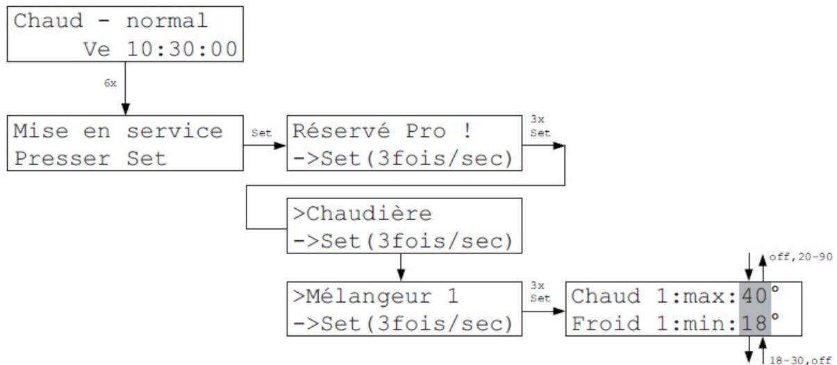
Dans le Menu Mélangeur 1, il est possible d'entrer séparément une température maximale pour le Mode de fonctionnement Chaud et une température minimale pour le Mode de fonctionnement Froid.
