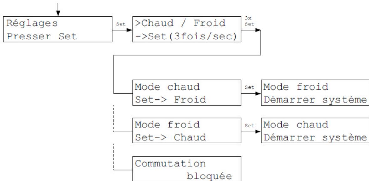
Dans le Menu Chaud / Froid, on peut passer du mode chauffage au mode refroidissement. Il faut pour cela presser la touche Set. La commutation doit d'abord avoir été autorisée dans le Menu Mise en service – Chaud/Froid. Si elle ne l'a pas été, le message *Commutation bloquée* apparaît.
