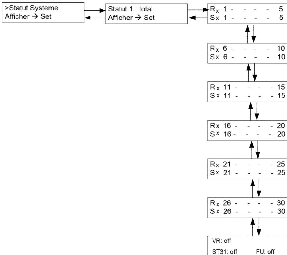
Dans le Menu Statut 1 : Total sont affichés tous les appareils (bus et radio) d'un seul coup d'œil. Les appareils manquants ou qui ont un problème sont signifiés par un point d'interrogation  $-?$ , qui clignote de façon alternative avec le numéro de l'appareil. Les Menus Statut 2 et 3 contiennent alors en général des informations plus précises sur le type de problème.
