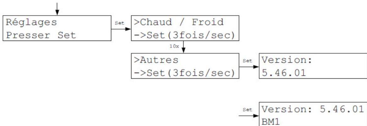
Le Menu Autres montre le numéro de la version du logiciel de fonctionnement. Une éventuelle variante du logiciel est affichée dans la deuxième ligne.
