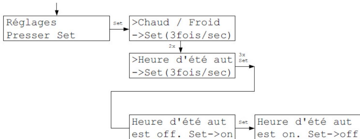
Quand la fonction Heure d'été – Automatique est active, l'horloge se règle sur l'heure d'été européenne : elle avance d'une heure le dernier dimanche de mars (à 2h00), et elle recule d'une heure le dernier dimanche d'octobre (à 3h00).
