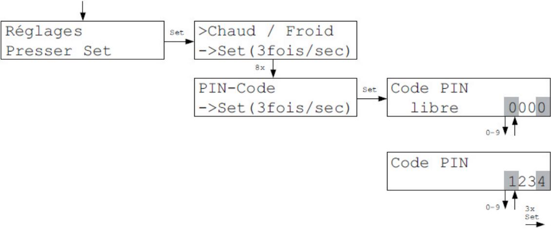
Dans le Menu Code PIN, on détermine le code d'accès pour la commande à distance de l'unité centrale ZE (par exemple via le logiciel PC-i).
