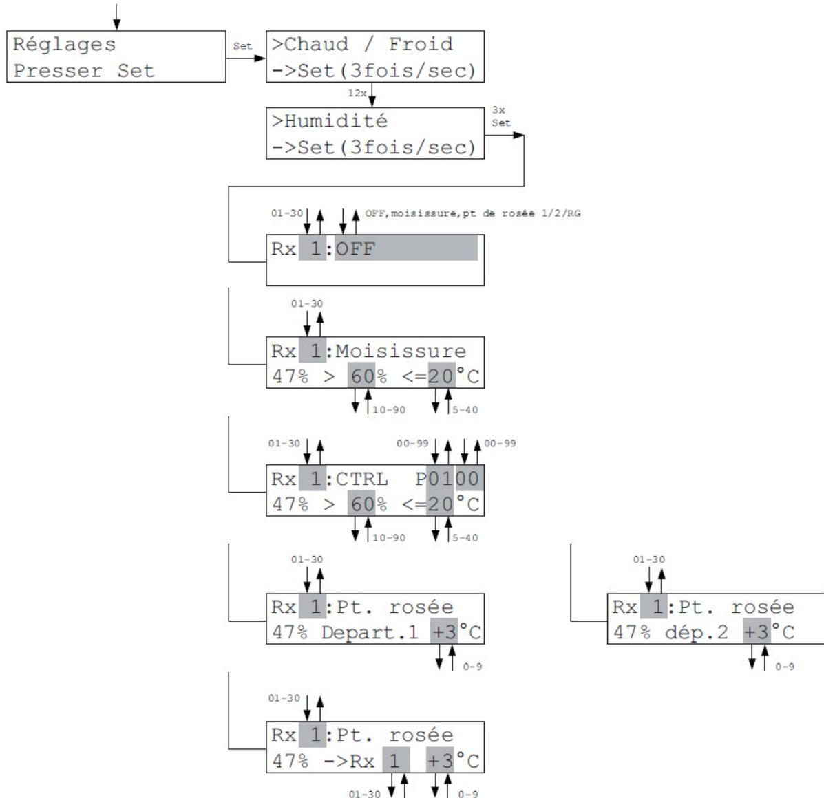
Dans le Menu Humidité, on peut sélectionner le type de régulation d'humidité pour chaque unité locale. De plus, on peut définir des valeurs limitatives pour la régulation d'humidité active. La valeur d'humidité mesurée apparaît toujours dans la deuxième ligne à gauche.
