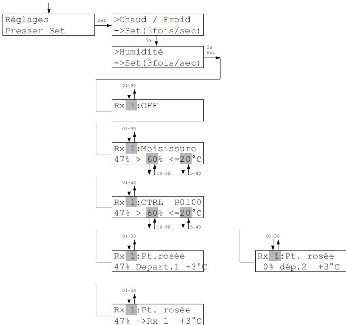
Dans le menu Humidité, il est possible de modifier des valeurs limites pour le réglage d'humidité activé. Le type de la régulation d'humidité activée dans le Menu de Mise en service Humidité définit quelles valeurs sont modifiables. La valeur mesurée est toujours affichée dans la deuxième ligne à gauche.
