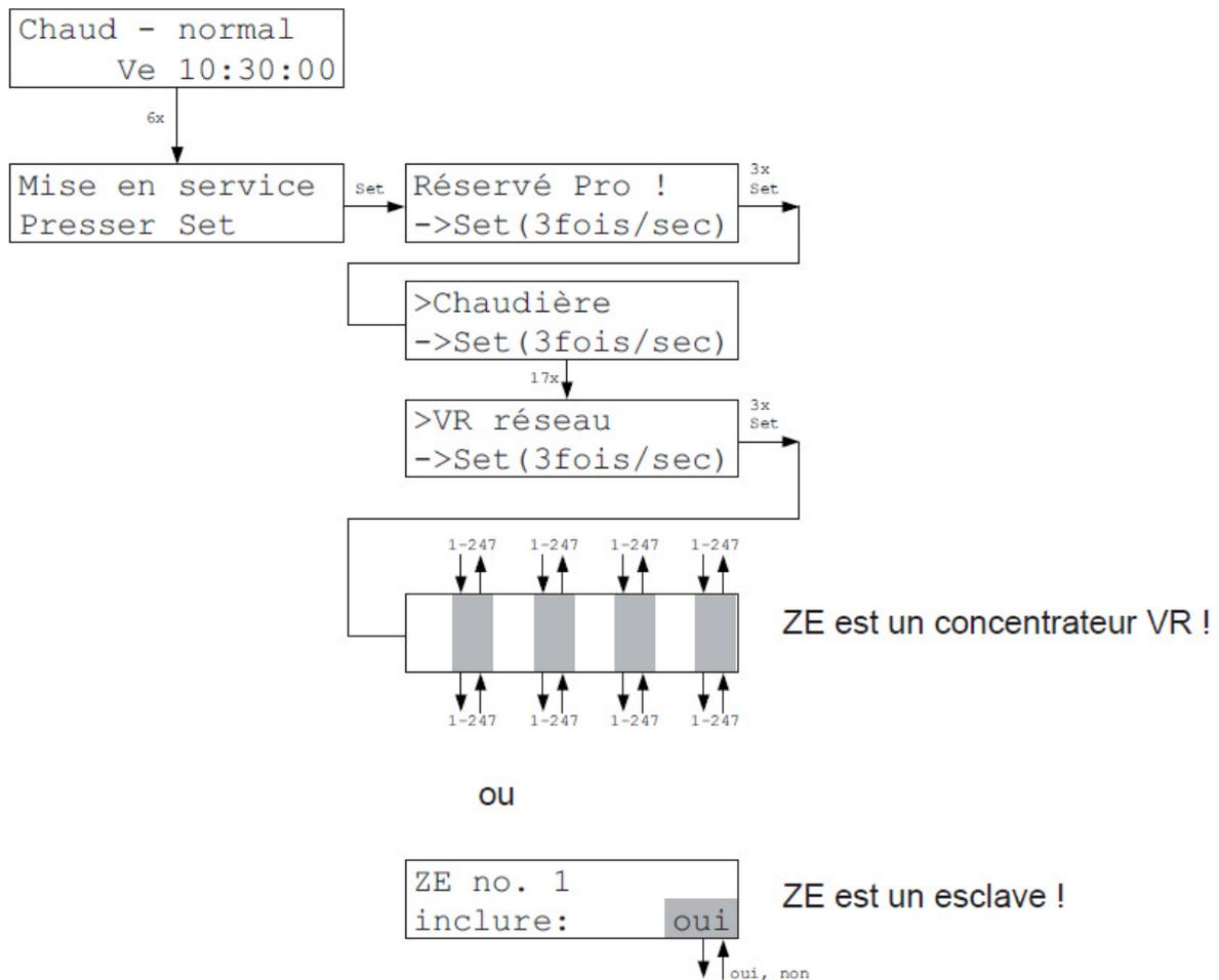
Le menu « VR réseau » permet d'entrer les informations nécessaires sur l'unité centrale ZE qui doivent être prises en compte sur le réseau pour calculer la puissance calorifique.
