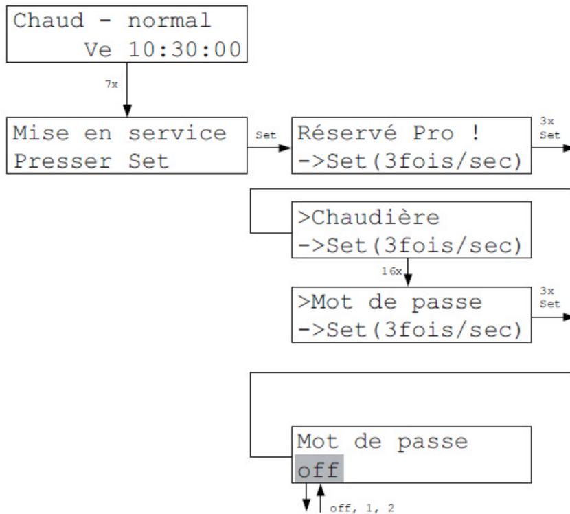
Le menu Mot de passe permet de verrouiller tout ou partie du menu. Les parties verrouillées ne sont alors accessibles qu'après entrée du mot de passe. Les menus Statut restent accessibles.
