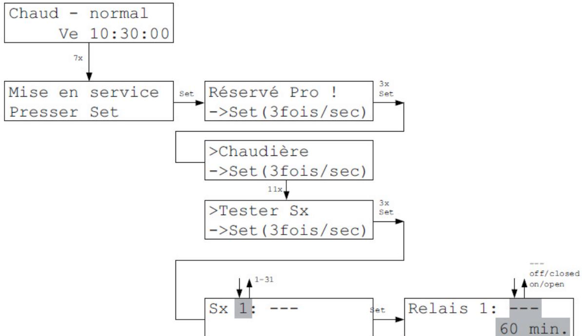
Dans le Menu Tester Sx, on peut brancher et débrancher chaque relais d'un commutateur ST/d'un moteur de vanne individuellement. Cela permet de vérifier si le relais est bien raccordé et si les adresses entrées sont correctes.
