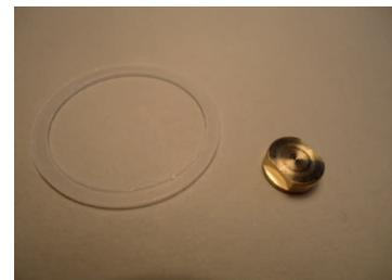
**Si le SF n'ouvre pas la vanne entièrement**, on peut augmenter la distance entre poussoir et centre de la vanne à l'aide d'une bague de distance (Bague de distance SF/SF 0,5 mm). Pour cela, dévisser le SF et placer une bague de distance dans l'écrou. On peut utiliser plusieurs bagues de distance. Chaque bague de distance augmente l'écart de 0,5 mm. Le montage est alors fini.
