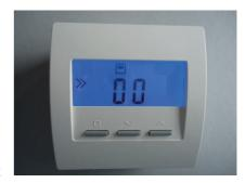
Chaque sonde d'ambiance RG ou RS ou RF doit avoir une propre adresse de 1 à 30. Ces adresses servent à l'identification de l'appareil à l'intérieur du système bus d'une unité centrale ZE. Une adresse ne doit être attribuée qu'une seule fois au sein du même groupe RG/RS/RF et de la même unité centrale. Au sein d'un autre groupe (par exemple ST/SK/SF) ou d'une autre ZE, on peut donner la même adresse à nouveau et c'est d'ailleurs souvent nécessaire et utile.
