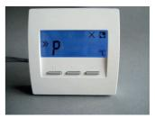
Si les modes Nuit ou Party sont sélectionnés, le réglage sera valable pendant 8 heures. Ensuite, le mode Jour repart automatiquement. Les modes Jour et Off restent eux cependant actifs de façon permanente. En mode Off, la pièce bascule en Hors gel en cas de chauffe, et en Off en cas de rafraîchissement.
