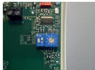
L'adresse de l'appareil se règle à l'aide des commutateur rotatif et commutateur DIP bleus.
