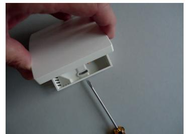
Le crochet de fermeture est alors libéré et la partie supérieure peut être basculée vers le haut et vers l'arrière avec la platine électronique. La partie supérieure pend maintenant aux deux câbles pour le bus THZ. Si on la retourne délicatement, on peut apercevoir les deux commutateurs bleus pour l'adresse de l'appareil.
