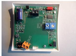
Si une sonde extérieure ou un interrupteur doivent être utilisés, connecter les câbles concernés au terminal gris-noir. La polarité n'a pas plus d'importance ici.
