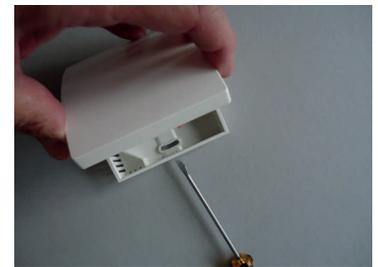
Si on soulève en même temps légèrement le haut du boîtier avec la main gauche, le crochet ne se referme pas après le relâchement. Le crochet de fermeture est libéré et la partie supérieure peut être basculée vers le haut et vers l'arrière avec la platine électronique. Mettre de côté la partie supérieure avec précaution.
