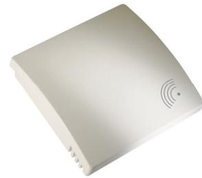
Pour améliorer encore la qualité de la réception, jusqu'à 4 récepteurs radio FE peuvent être liés à une ZE. Les éléments radio sont ainsi réceptionnés par plus d'un seul récepteur radio, ce qui augmente la sécurité de transmission.
