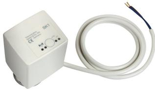
Les moteurs proportionnels SK intègrent une fonction d'équilibrage hydraulique automatique ; ils calculent en permanence le débit optimal de chaque radiateur et s'adaptent de façon dynamique, ce qui limite l'intervention de l'exploitant et assure une efficacité constante du bâtiment, génératrice d'économies de frais d'entretien.
