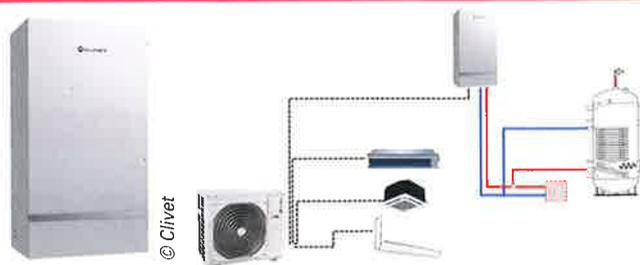
*HYDRO-M, unité de production d'eau chaude jusqu'à 60°C pour les systèmes MULTI Split, pour réaliser un système de climatisation, de chauffage de l'eau et de production d'eau chaude sanitaire en une seule solution.*
